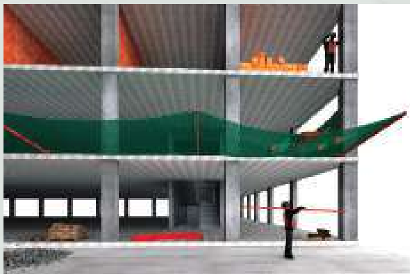
Moduł LiteMESH w konfiguracji mocowania górnego.
