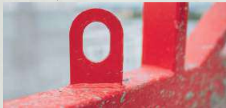
Mocowanie zawiesia dźwigu.
